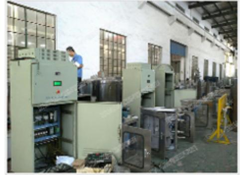
La centrífuga de descarga superior con bolsa de filtro PSD es un equipo de separación de sólido-líquido con un diseño de placa base. Esta serie de centrifugas industriales presenta una estructura simple, rendimiento confiable, operación y mantenimiento sencillos. El tiempo de filtración permite un ajuste libre, resultando en un lavado de torta efectivo y una fase de sólidos no dañada. Además, la bolsa de filtro puede ser limpiada fácilmente.
